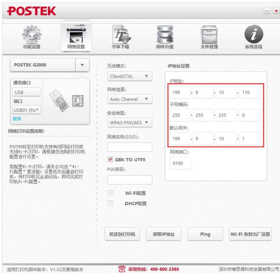
图 2-26 设置打印机网络参数
