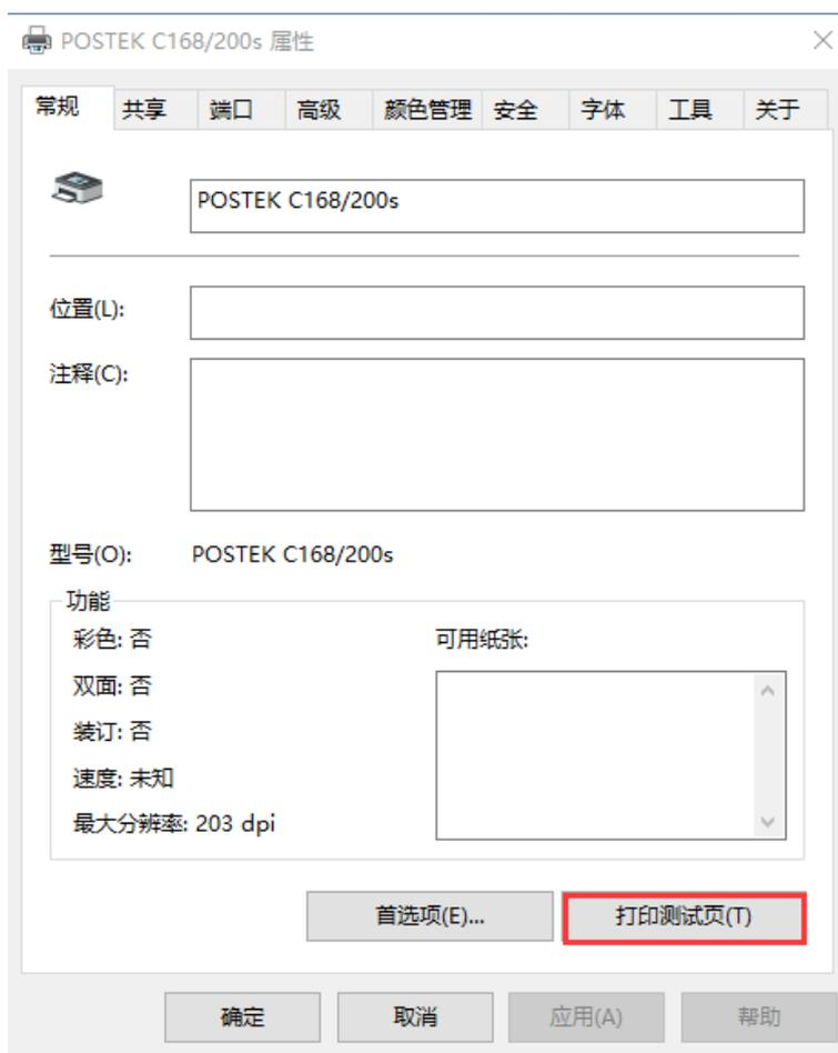
图 2-36 打印测试标签
