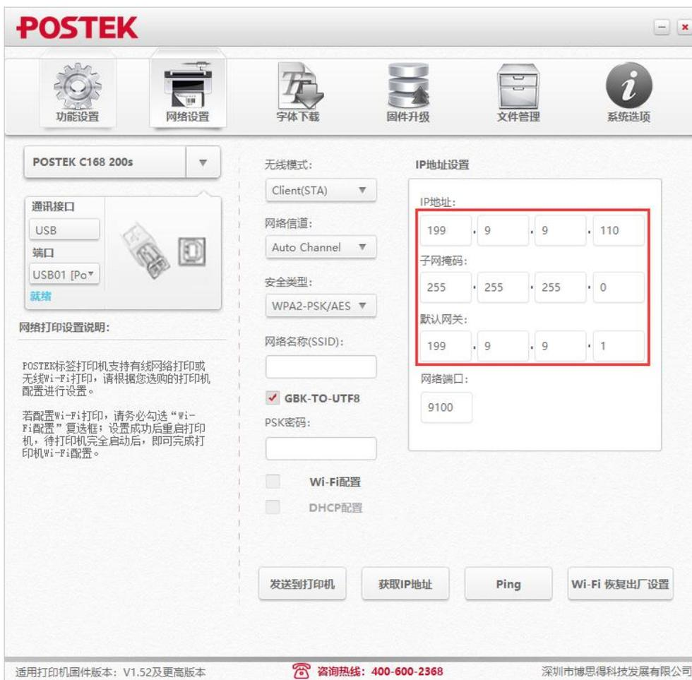
图 2-39 设置打印机网络参数
